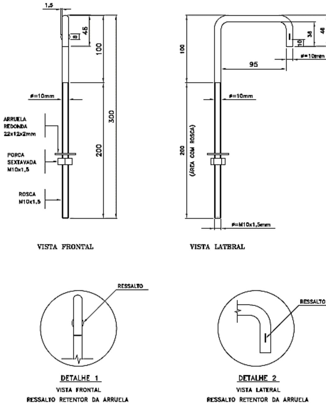
Figura 1 – Parafuso Tipo J para Banco de Capacitores
